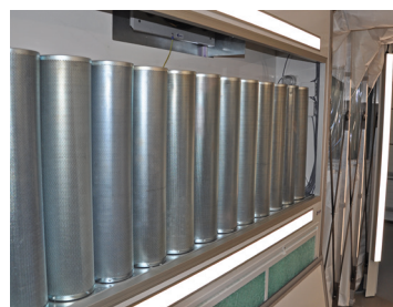
Af hensyn til arbejdsmiljøet er filtrering af luften alfa og omega i de mobile kabiner, hvor lakskader udbedres.
